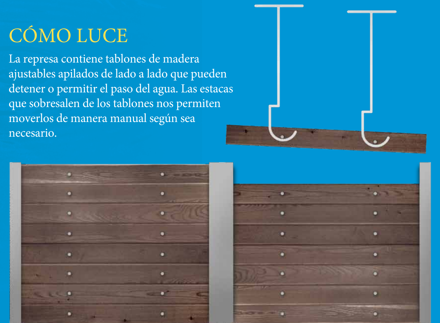
Usamos dos ganchos especiales para agregar o quitar tablonces.
